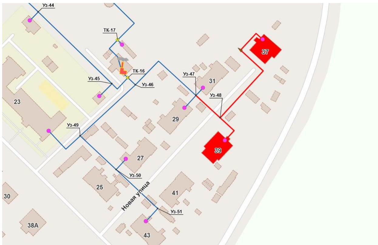
Рисунок 8 - Визуализация отключения запорной арматуры
